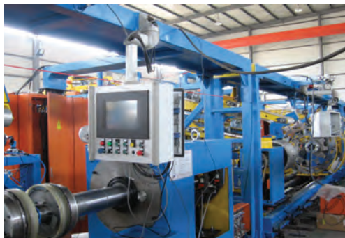
作者: 沈丽强 单位: 天津昆仑星辰科技有限公司北京办事处 品牌: ADVANTECH-研华科技 型号: IPPC-9150 应用领域: 橡胶机械 采购/使用年份: 2005年 应用单位: 广州华南轮胎厂 控制用途: 用于轮胎成型机的连续控制监控 在用数量: 26 上传时间: 2008-1-16 22:31:00
