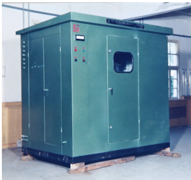
图 12 ZFK-1 型转炉煤气自动回收分析装置
